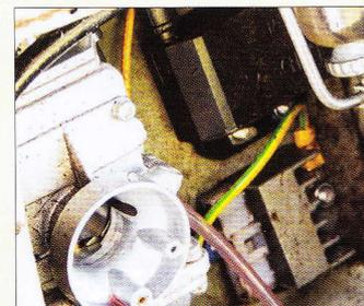
Blick unter die Vergaserklappe: 24 Mikuni CDI und Spannungsregler.
